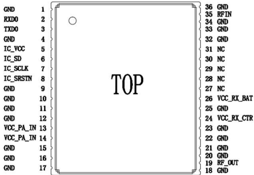
图 2-1 MT1310 型模块引脚分布
